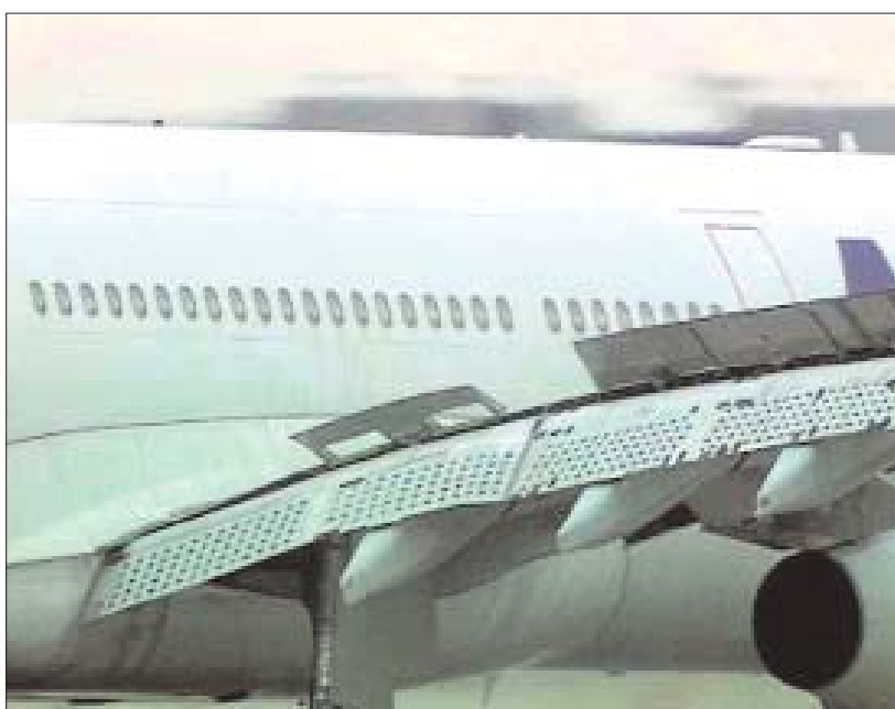
Imagen del "Inboard" y el "outboard" fabricados por Grupo Aciturri y montados en el A340 para realizar las pruebas de vuelo
